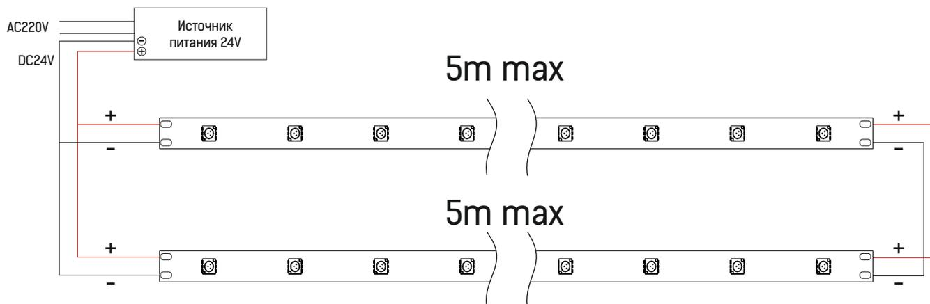
ПРИМЕЧАНИЕ: Обратитесь к схеме подключения для установки. Неправильное подключение может привести к короткому замыканию!
